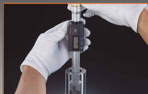
Typische Anwendung eines Holtests
